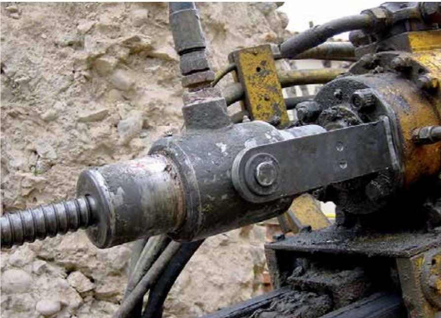
Para la mayoría de modelos de martillo, tenemos disponibles cabezales de inyección para conectar el miembro portante de acero y la estación de bombeo al martillo de perforación.
