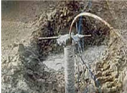
La deformación del acero sobre la longitud de inyección se midió en varios ensayos. Para ello se fijó un extensómetro en el interior de una barra. Los resultados de los ensayos mostraron que los estratos de suelo poco competentes no participan en la transmisión de carga, de modo que se forma una longitud "libre" efectiva.
