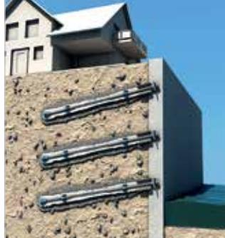
Micropilote TITAN según EN 14199 para anclajes de retrofijación. Transmisión de cargas de tracción hasta estratos profundos de suelo competente.
