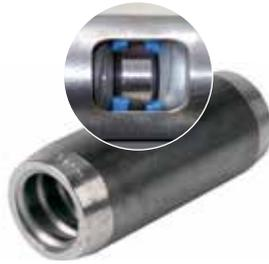
Según nuestra homologación no se necesita contratuercas tal como otros sistemas los exigex. El manguito de empalme permite soportar tanto cargas cíclicas como cargas dinámicas con cambio de signo. Esto es gracias al tope central (anillo metálico con juntas). Gracias al pretensado contra el tope central al apretar el roscado, se consigue una transmisión óptima de la energía de golpeo durante el proceso de perforación.
