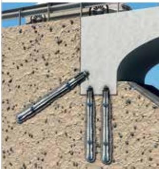
Micropilote TITAN según EN 14199 para cimentaciones/recalces. Transmisión de cargas de compresión y tracción hasta estratos profundos de suelo competente.
