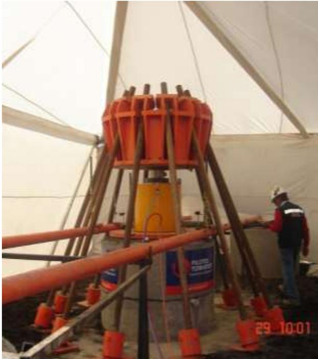
Este tipo de ensayos es muy costoso por la estructura de reacción necesaria, cuando se sobrepasan aproximadamente las 800 a 1000 ton de carga de prueba.
