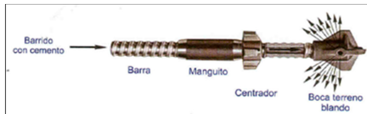
Figura 9. Barras del tipo TITAN 40/16 empleadas para la ejecución de las inyecciones lanza
