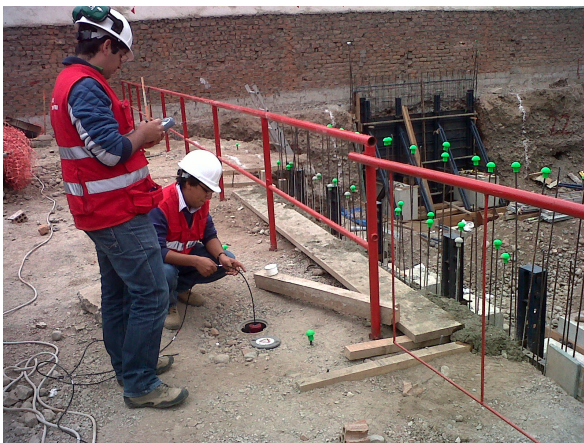
Figura 9. Personal técnico durante la toma de mediciones con el inclinómetro
