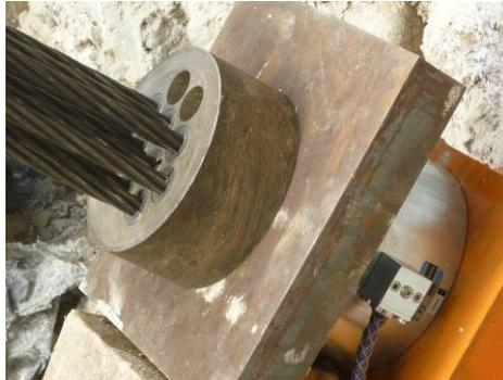
Fig. 7 – Celda de carga en anclaje de 9 cables
