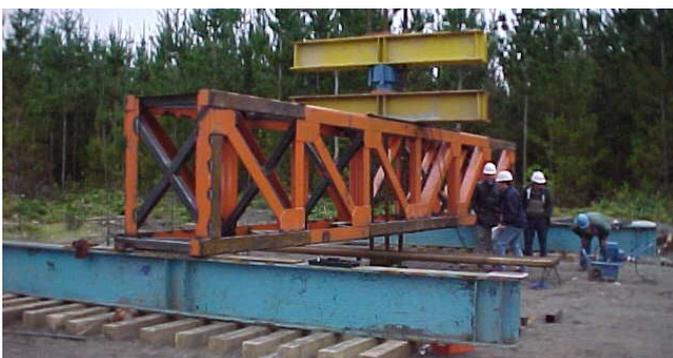
Foto 3: Ensayo tracción axial pilote  $\phi$  1000 mm.
