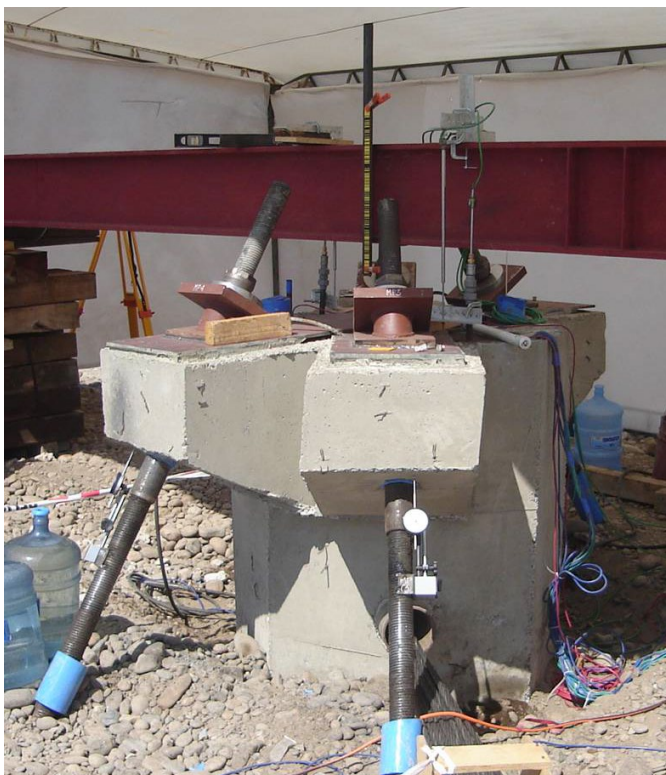
Foto 3: Ensayo de Aptitud Axial.
