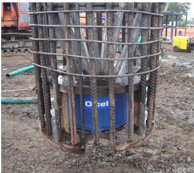
Foto 2: Celda o Célula de Osterberg (O-cell).
