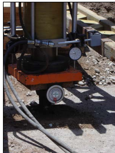
Figura N°9: Estructura de reacción ensayo a compresión
