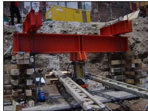
Figura N°8: Estructura de reacción ensayo a compresión
