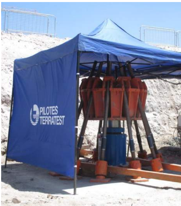
Figura 9. Disposición de relojes comparadores y gato hidráulico.
