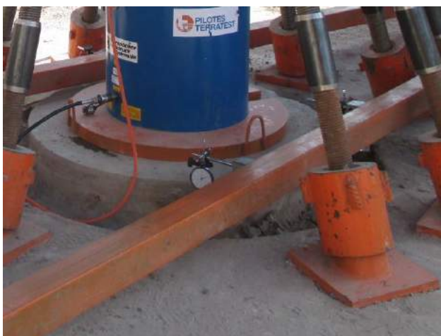
Figura 9. Disposición de relojes comparadores y gato hidráulico.
