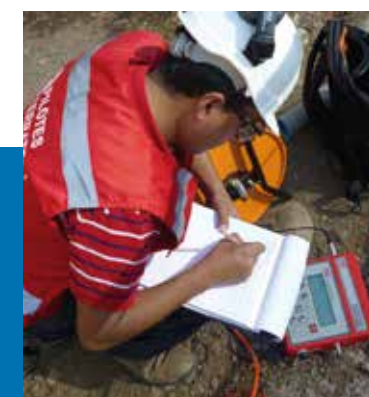
MEDICIÓN INCLINOMETROS, EDIFICIO CERRO EL PLOMO.
