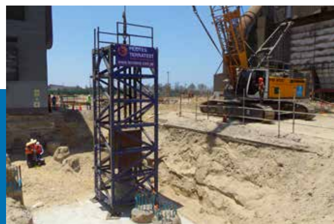
ENSAYO DE CARGA DINÁMICA, AMPLIACIÓN PLANTA DE ACEROS AREQUIPA
