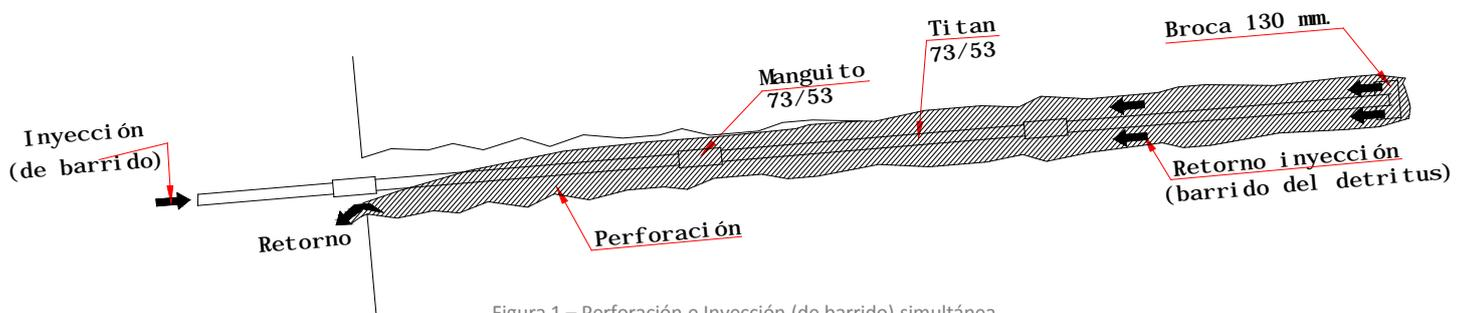
Figura 1 – Perforación e Inyección (de barrido) simultánea
