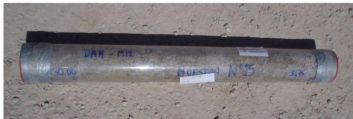
Foto 3 - Disposición de Testigos en Liners Transparentes (L=0.75 m y Ø= 88.9 mm)
