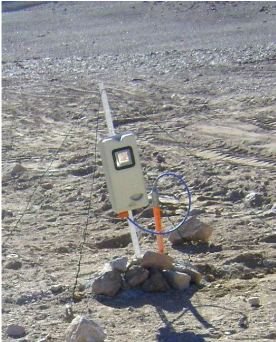
Imagen 3 – Pozo Terminado c/medidor de Temperatura
