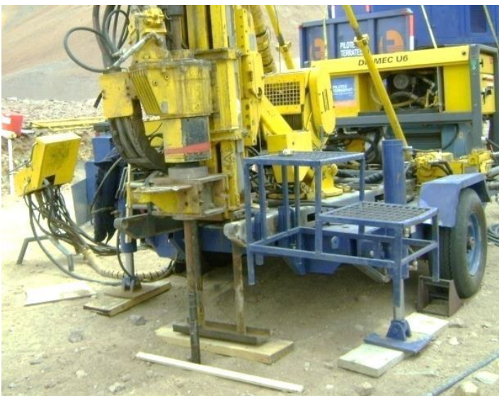
Imagen 5– Equipo de diamantina Atlas Copco U6
