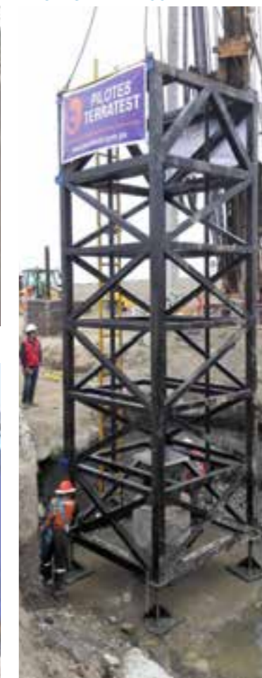
ENSAYO DE CARGA A PILOTE CFA, AMPLIACIÓN AEROPUERTO DE SANTIAGO, CHILE.
