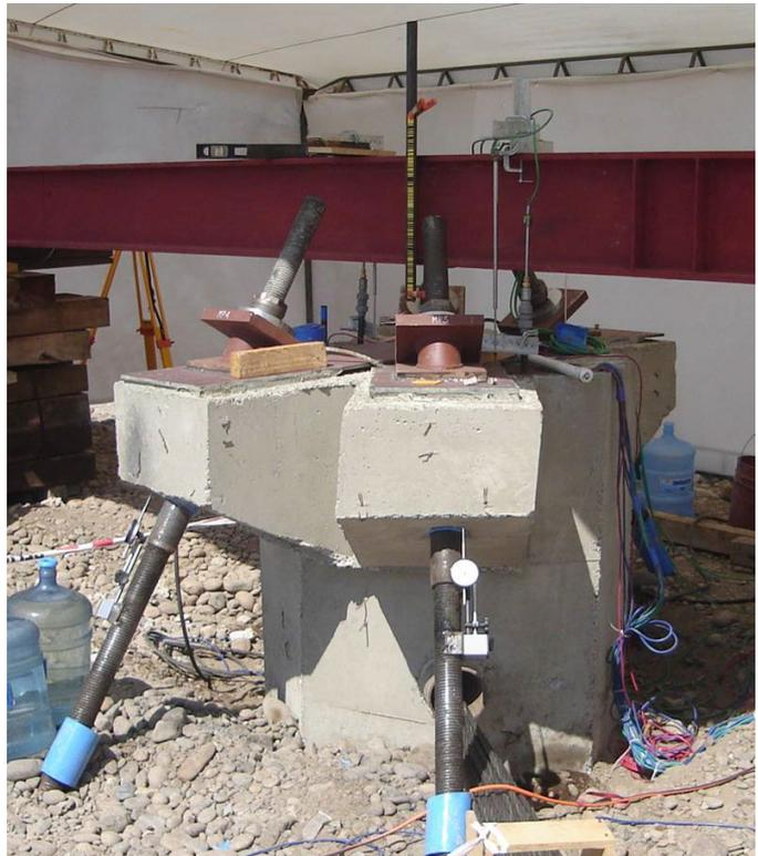
Figura 10 - Ensayo de Aptitud Axial.
