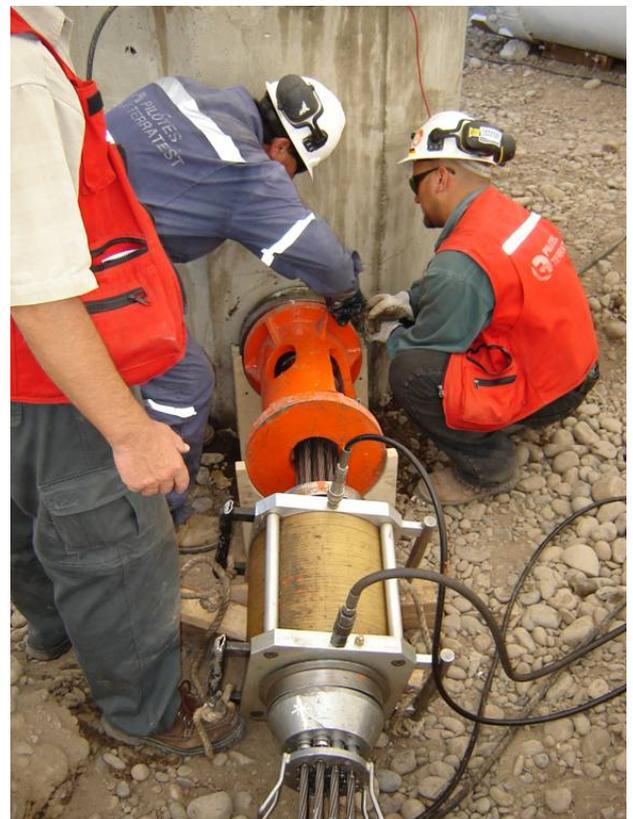
Figura 7- Ensayo de Aceptación a Carga Lateral.
