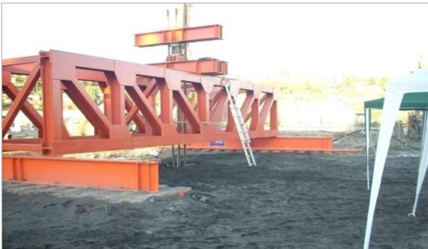
Fig. 7: Viga Reticulada– Ensayo a tracción
