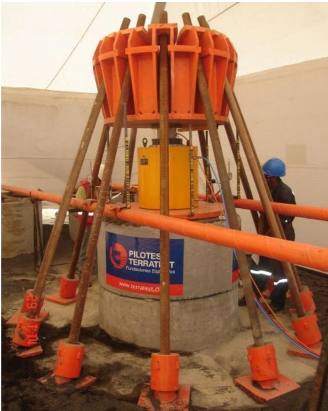
Fig. 4: Corona de reacción – Ensayo a compresión
