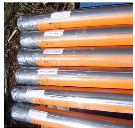
Foto 9 – Muestras inalteradas para caracterización y ensayos geotécnicos en laboratorio
