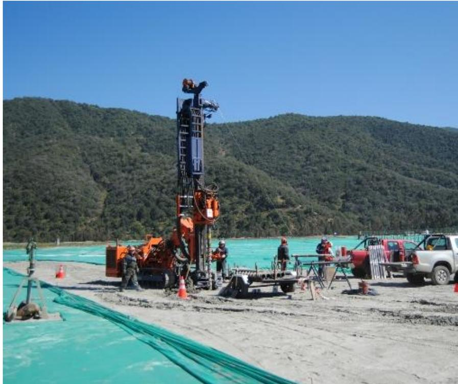
Foto 6 – Sondajes Relaves Minera Florida Figura 1 (der) – Detalle de Sistema Hollow Stem Auger
