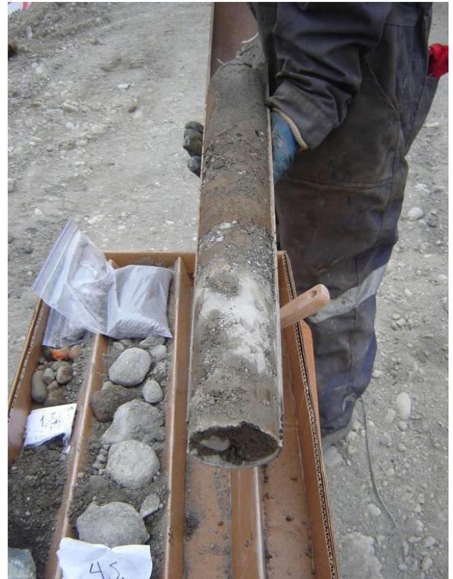
Figura 5 – recuperación de muestras inalteradas
