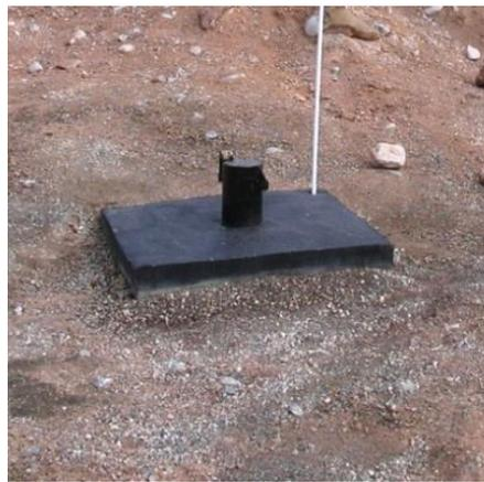
Foto 8 – Detalle piezómetro de monitoreo de napa subterránea
