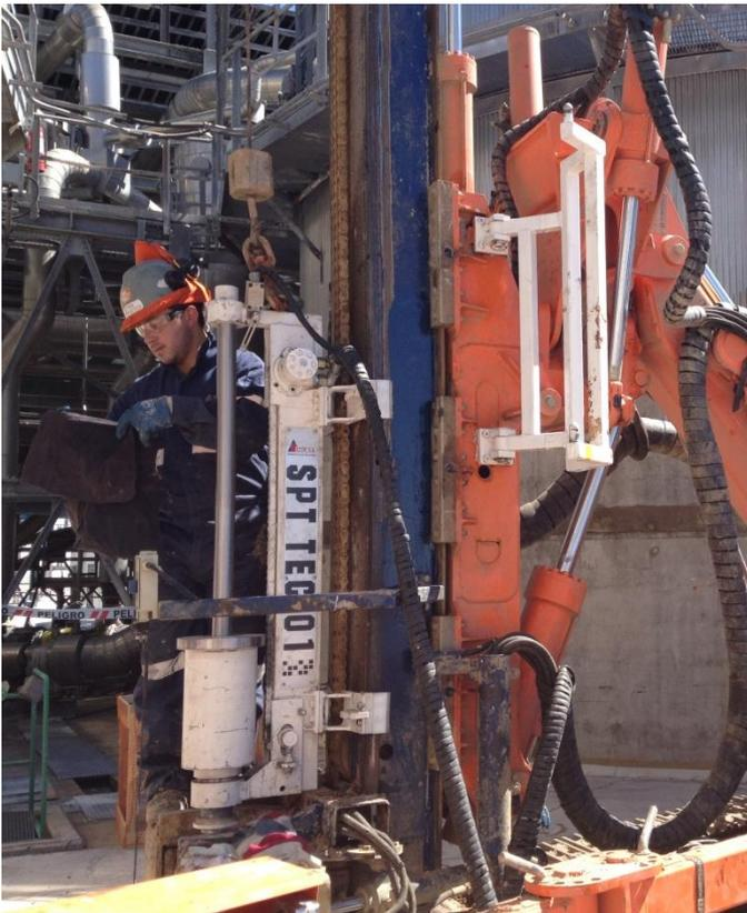
Imagen 7 – Ejecución de ensayo geotécnicos SPT.
