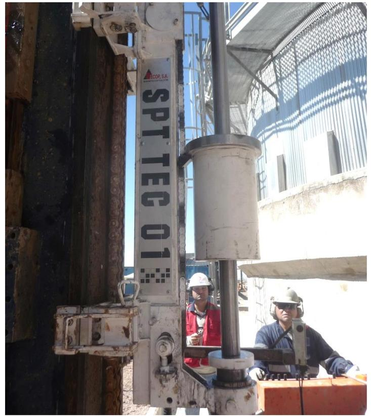
Imagen 8 – Penetrómetro SPT TEC01.
