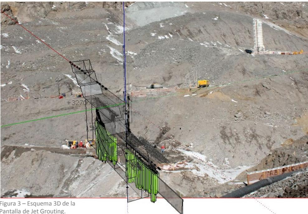
Figura 3 – Esquema 3D de la Pantalla de Jet Grouting.
