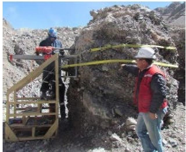
Imagen 3- Extracción de Testigos de la Columnas para Ensayos de Permeabilidad y Resistencia en Laboratorio Externo.
