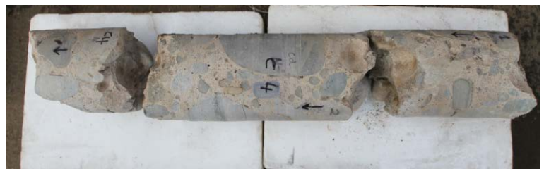
Testigo obtenido para ensayos de laboratorio.
